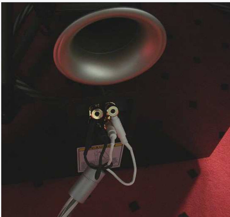
Das Lautsprecherkabel-Anschlussterminal. Darüber die Austrittsöffnung des Bassreflexrohres
